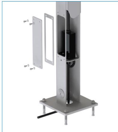
Kabelführung durch Fussplatte
